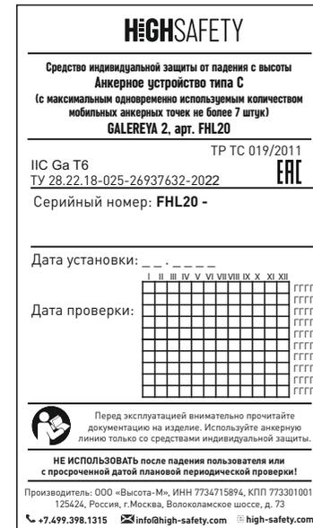
**Рис. 3** Маркировка информационной таблички анкерной линии GALEREYA 2.
